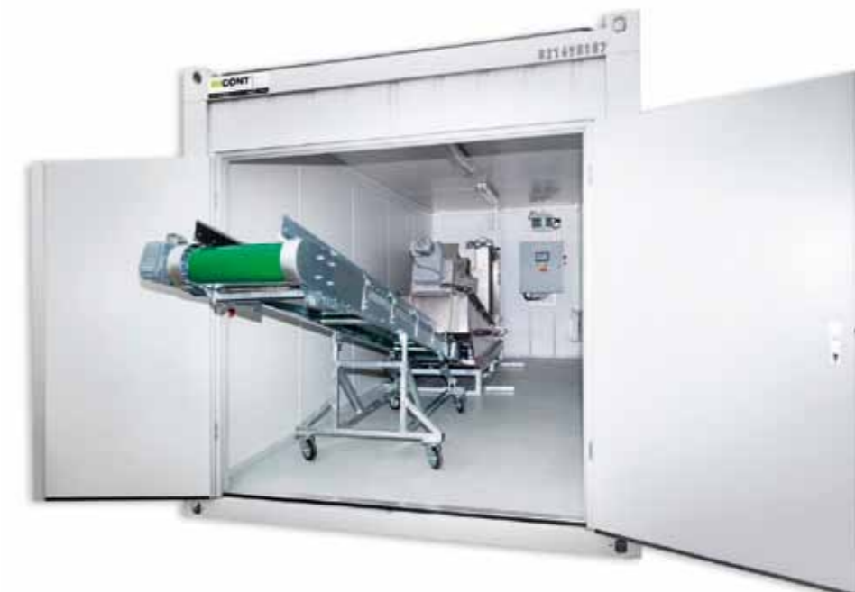
Vestavba odvodňovacího stroje a pásového dopravníku do zatepleného kontejneru
